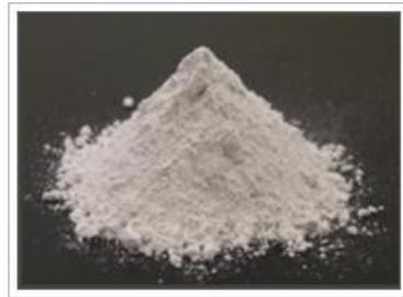
重金属イオンの難溶化による化学的吸着と細孔への物理的吸着のW効果により汚染土壌中重金属類の長期安定化を実現した重金属汚染対策材。
